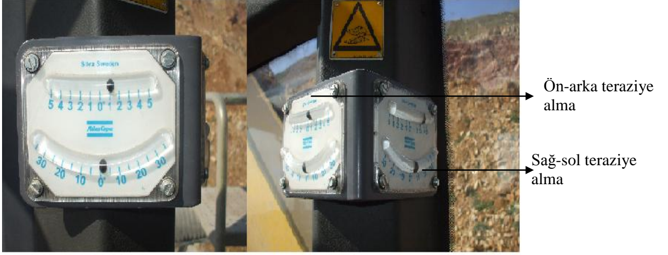
Resim3- Delici makinenin teraziye alınması
